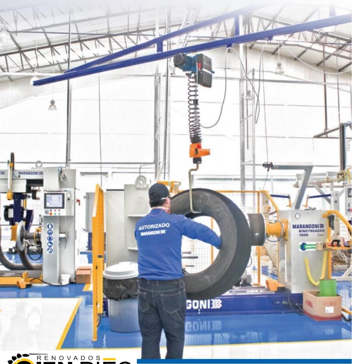
Sistema de anillo único en el mundo fabricado por Marangoni, que elimina los fallos en las uniones de las bandas del sistema tradicional.
